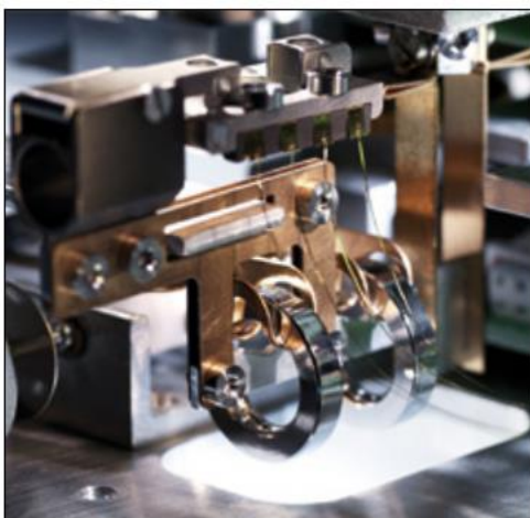
Рисунок 14 – Внутренние кольцевые калибровочные гири ультрамикровесов Меттлер Толодо [140]
