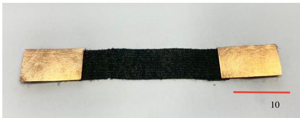
Рисунок 30 – Вид образца трикотажного композита с электродами
